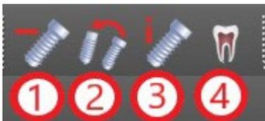
Le operazioni 1 e 3 vengono usate nello stesso modo: si fa clic sull'icona, si sposta il cursore sull'impianto e poi vi si fa clic. Per l'opzione di sostituzione dell'impianto (2), compare la stessa finestra di dialogo come per l'aggiunta dell'impianto, per scegliere con quale impianto desideriamo sostituire quello selezionato.
