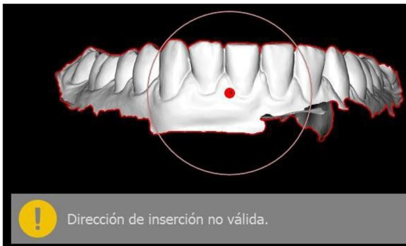
Si la dirección de inserción no se ajusta de manera correcta, la **flecha se vuelve roja**, el usuario recibirá el mensaje **Dirección de inserción no válida** y no podrá continuar. Es necesario ajustar la dirección correcta para poder continuar.
