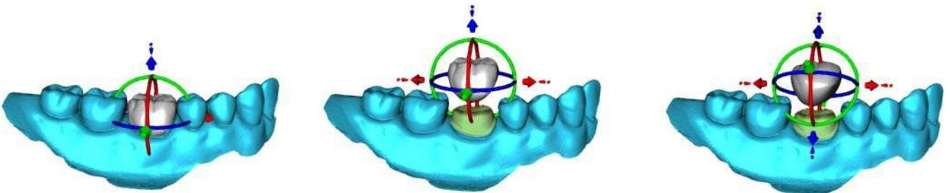
"Añadir/Eliminar" se utiliza para la adición/eliminación del material de la corona.
