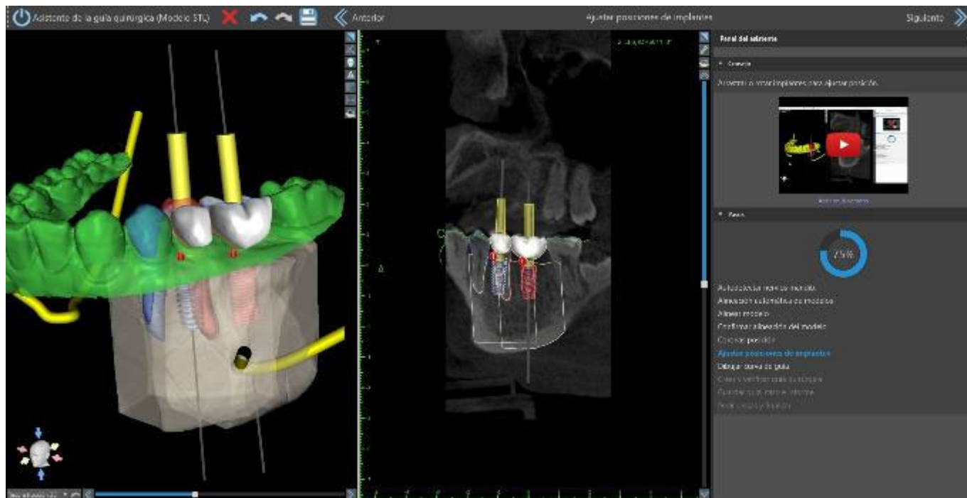
Colocación automatizada de la corona con segmentación local y extracción del diente
