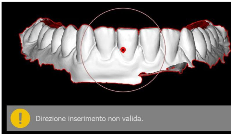
Se la direzione di inserimento non è impostata correttamente, **la freccia diventa di colore rosso**, l'utente riceve il messaggio **La direzione di inserimento non è valida** e non può proseguire. Per proseguire, è necessario impostare la direzione corretta.
