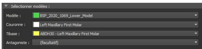
La tibase peut être choisie en cliquant sur la dent ou en cliquant sur la liste déroulante tibase. Si aucune base n'est sélectionnée, l'utilisateur ne peut pas aller plus loin.
